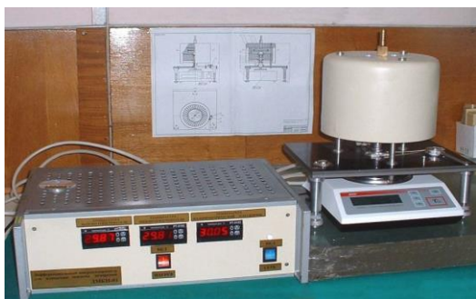
Рис. 1 – Зовнішній вигляд приладу для визначення теплофізичних характеристик їстівного покриття або плівки
