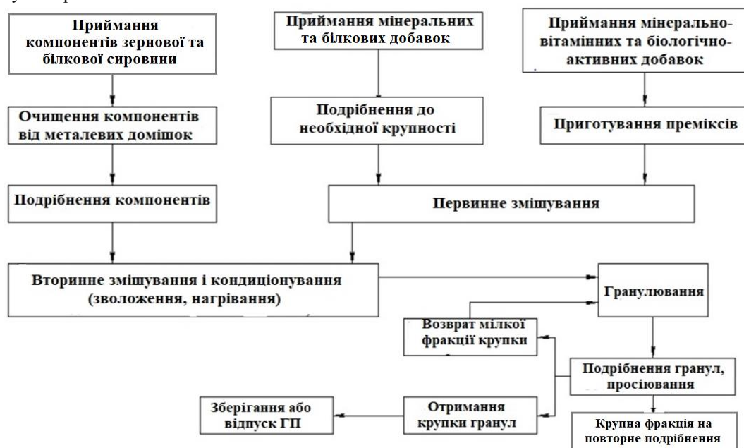
Рис. 1 - Структурна схема традиційної технології виробництва гранульованих комбікормів з отриманням крупки гранул
