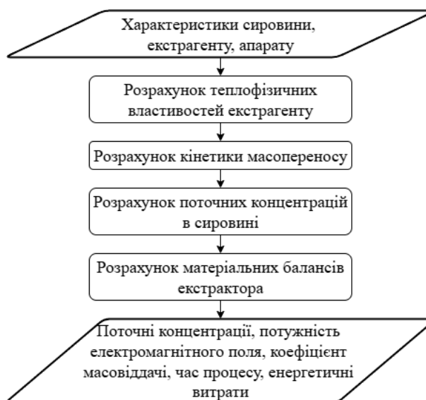
Рис. 1 – Алгоритм розрахунку електродинамічного екстрактора циркуляційного типу
