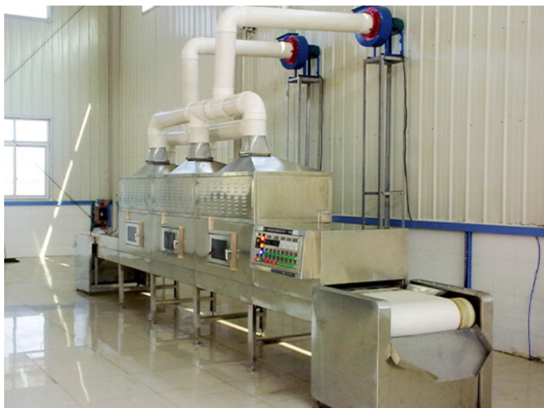
Рис. 1 – Установка для сушіння харчових продуктів MiD-80
