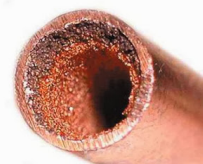
– Теплова труба з капілярно-пористою структурою [9]
