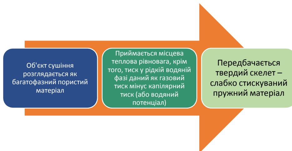
Рис. 3 – Припущення в моделюванні термовологомеханіки сушіння
