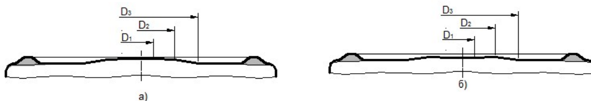
а) мембрана у ненавантаженому стані; б) мембрана у стані втрати стійкості
