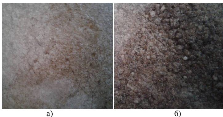
Рис. 9 – Продукти «гарячого» способу переробки макухи амаранту: а) – клейстеризований крохмаль; б) – білковий концентрат
