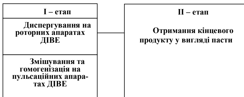
Рис. 1 – Блок-схема ДІВЕ-технології отримання паст з ягідної сировини
