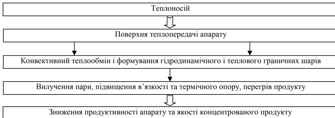
Рис. 1 — Структурна модель традиційного випарного апарату
