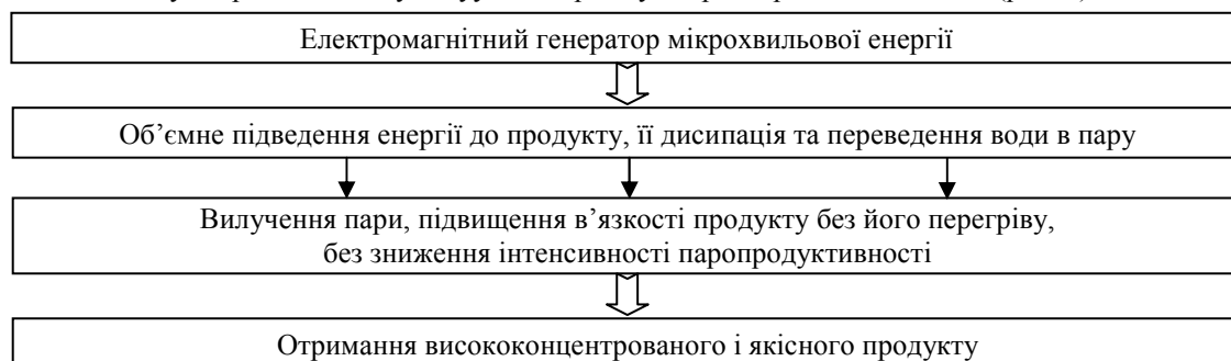
Рис. 2 — Структурна модель мікрохвильового випарного апарату
