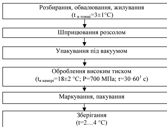
Рис. 1 — Технологічна схема виробництва «Шинки з білого м'яса» за допомогою оброблення ВГТ
