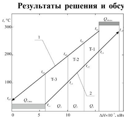
Рис. 2. Температурно-энтальпийные профили теплоносителей двухпоточковой системы теплообмена.
