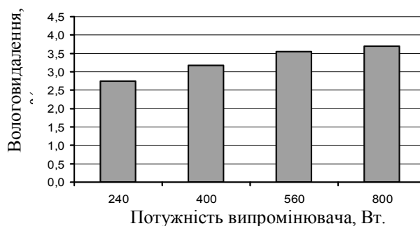
Рис. 4 – Залежність результуючого зниження вологості сировини від потужності випромінювання МХ генераторів
