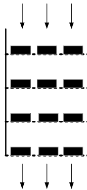
Рис. 1 – Схема контейнера для сушіння цукатів
