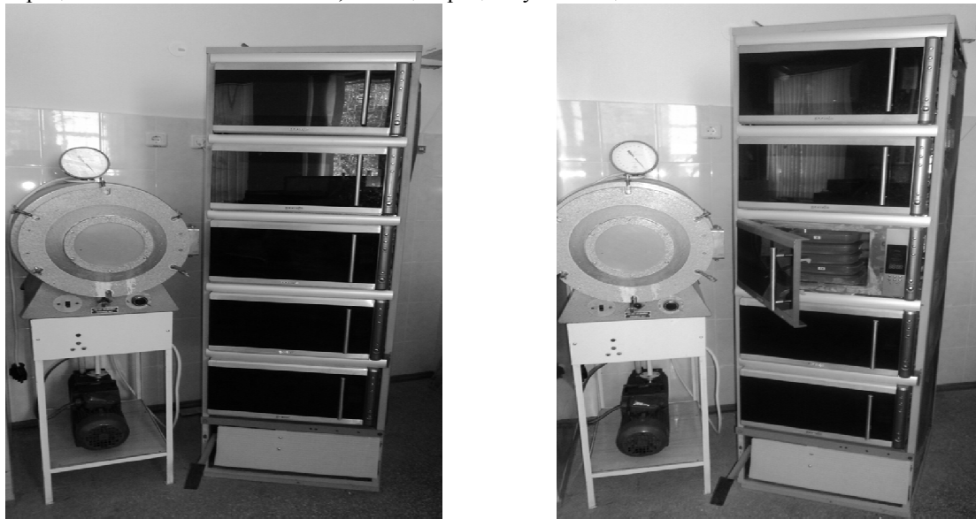
Рис.3 – Микроволновой экстрактор кофе
