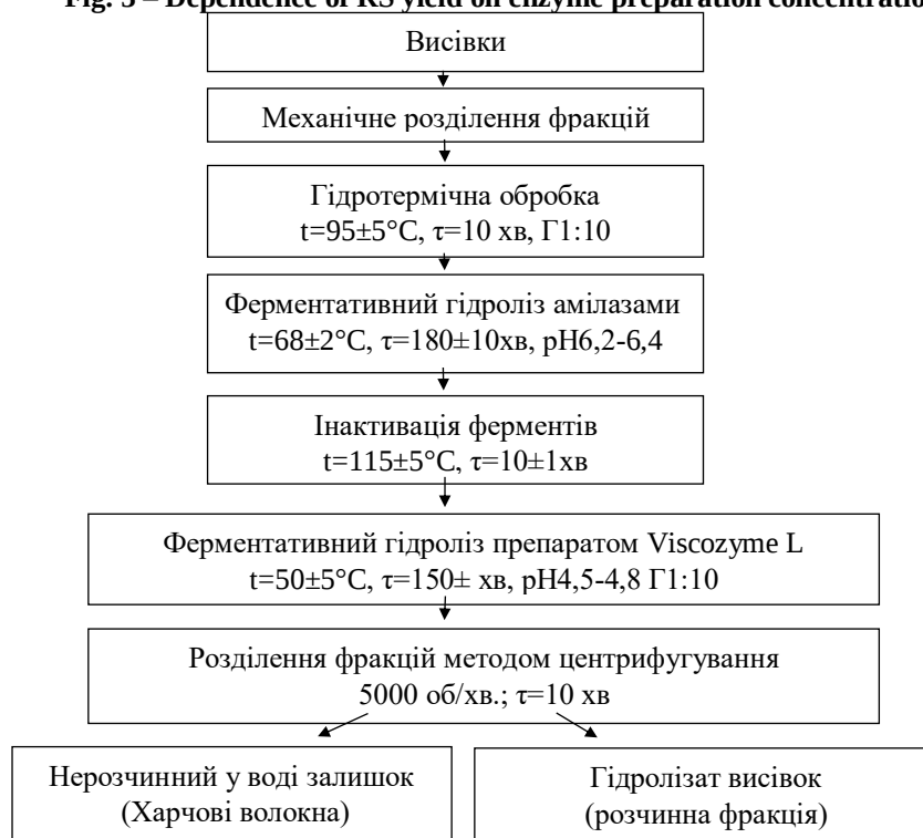
Рис. 4. – Загальна схема ферменталізу пшеничних та житніх висівків Fig. 4 – General scheme of enzymatic hydrolysis of wheat and rye bran
