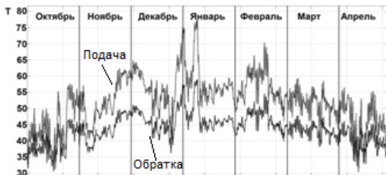
Рис. 3 — Изменение температур «подачи» и «обратки» в течение отопительного сезона
