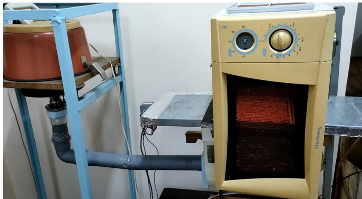
Рис. 1 – Загальний вигляд дослідного стенду: зліва – вентилятор продувки, справа – МХ камера (мікрохвильова піч) з фрагментами транспортних тунелів, всередині камери - касета з матеріалом.
