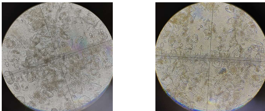
Рис. 4 – Мікроструктура гарбузового пюре з 7 циклу ДІВЕ-обробки в РПА. Збільшення 7х10. Масштаб: 1 поділка = 16мкм.
