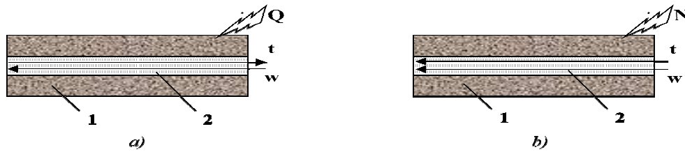
а) – традиційна схема; б) – в умовах МХ поля; 1 – тверда фаза; 2 – капіляр.
