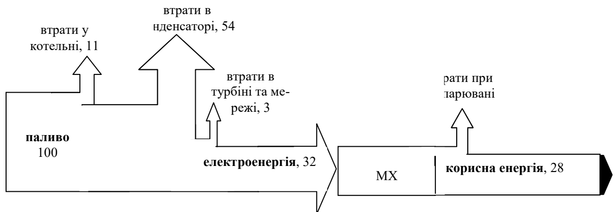
Рис. 3 – Конверсія енергії палива при виробництві сухих продуктів в електродинамічних дегідраторах
