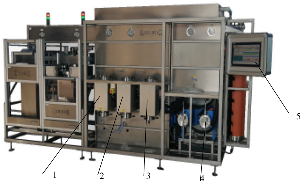
1 – екстрактор, 2 – сепаратор, 3 – сепаратор для співрозчинника, 4 – компресор, 5 – блок управління
