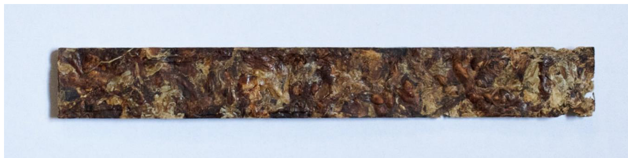
Рис. 2 – Зразок брикетованого альтернативного твердого палива з осушеного бурякового жому
