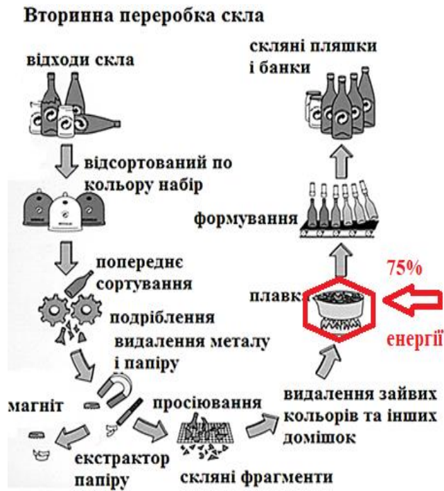
Рис.1. – Схема переробки скла
