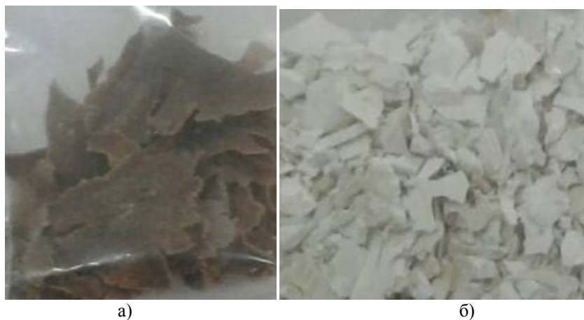
Рис. 7 – Продукти «холодного» розділення макухи амаранту: а) – білковий концентрат; б) нативний крохмаль
