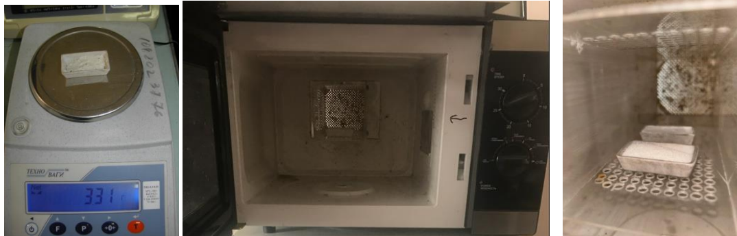
Рисунок 4 – Підготовка до проведення експерименту по визначенню ефективності нагрівання порошку оксиду алюмінію в мікрохвильовій камері
