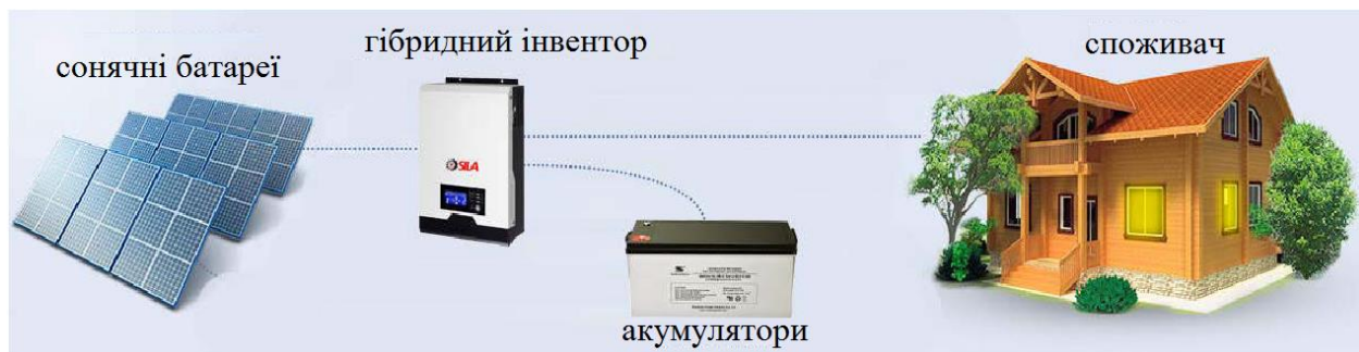
Рисунок 9 – Автономна робота гібридної сонячної електростанції
