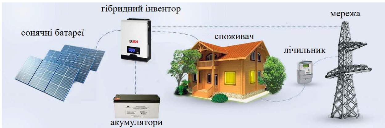
Рисунок 8 – Робота гібридної сонячної електростанції спільно з електромережею
