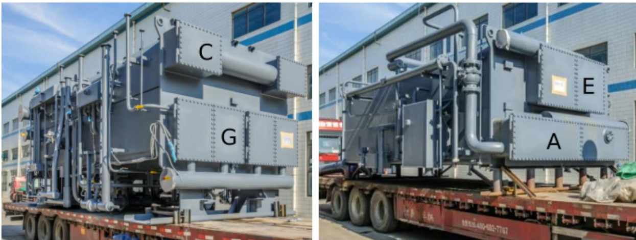
Рисунок 6 – Абсорбційний термотрансформатор: Ebara, номінальна потужність \approx 7 МВт: А – Абсорбер; G – Генератор; E – Випарник; C – Конденсатор (усі права захищено, Авторське право Ebara Refrigeration Equipment & Systems Co., Ltd. 2019) [6]
