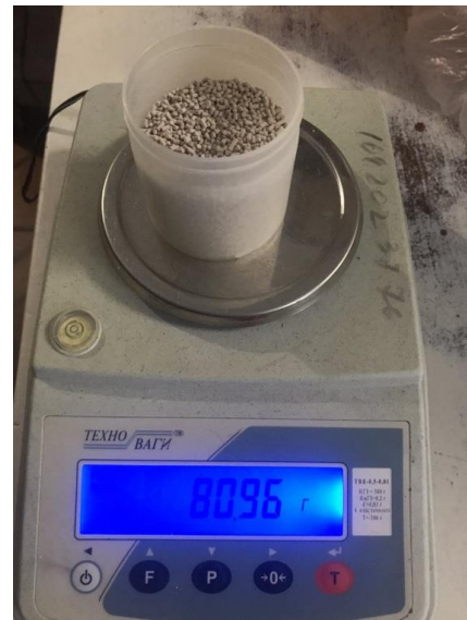
Рисунок 7 – Зважування на електронних вагах ТВЕ-0,5-0,01 цеоліту 13X
