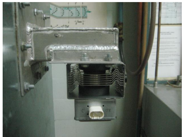
Рисунок 3 – Анодний блок магнетрону з ребрами охолодження
