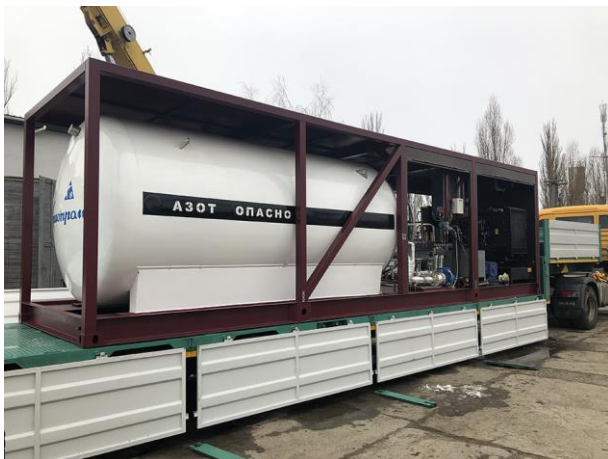
Рисунок 1 – Види на обладнання, змонтоване на каркасній рамі в габаритах контейнера типу «1 ВВ»
