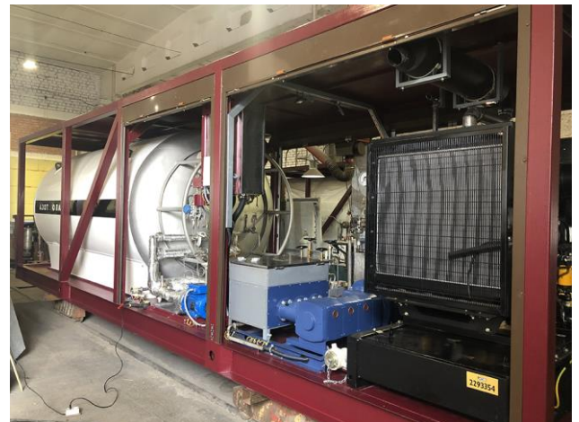
Рисунок 4 – Випарник та арматура високого тиску виробництва ВКФ «Кріопром»
