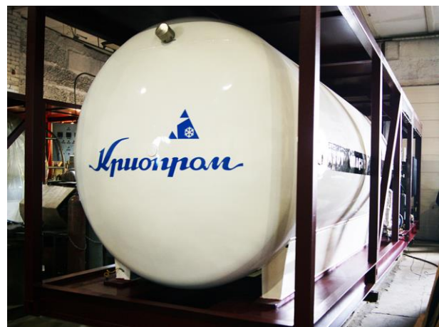
Рисунок 1 – Види на обладнання, змонтоване на каркасній рамі в габаритах контейнера типу «1 ВВ»
