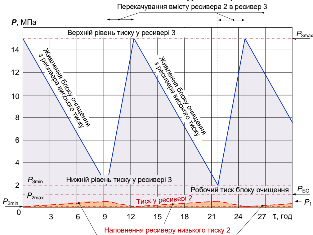
Рисунок 5 – Циклічна зміна тисків у ресиверах згідно з рис. 4
