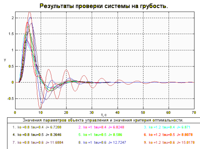
Рис. 11 – Результати оптимального параметричного синтезу і перевірки грубості САР з ПІД регулятором яка реалізує принцип управління за прогнозом на основі кубічного сплайну.
