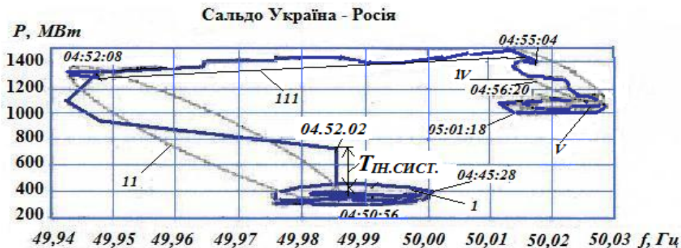
Рис. 2 – Фрагмент зміни сальдо між енергосистемами ОЕС України та ЄЕС Росії у 2003 році із-за несанкціонованого відключення енергоблоку 1000 МВт на одній із станцій АЕС
