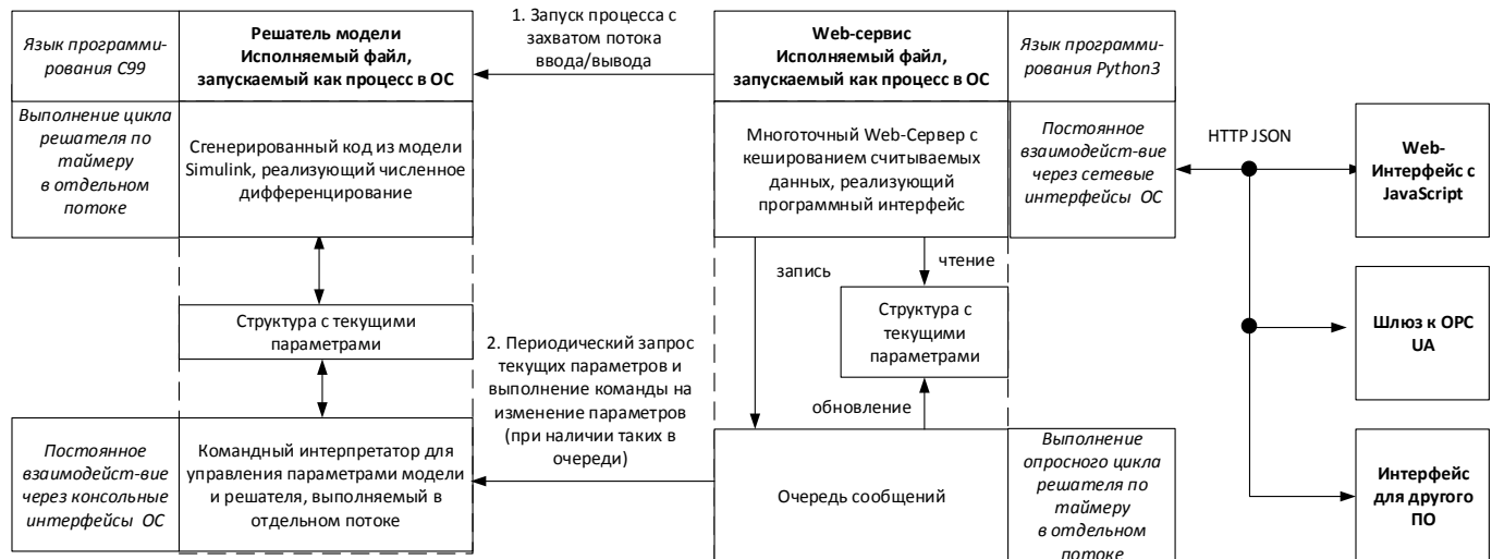
Рис. 1 – Структурная схема предлагаемого программного решения Fig. 1 – Schematic diagram of the proposed program solution
