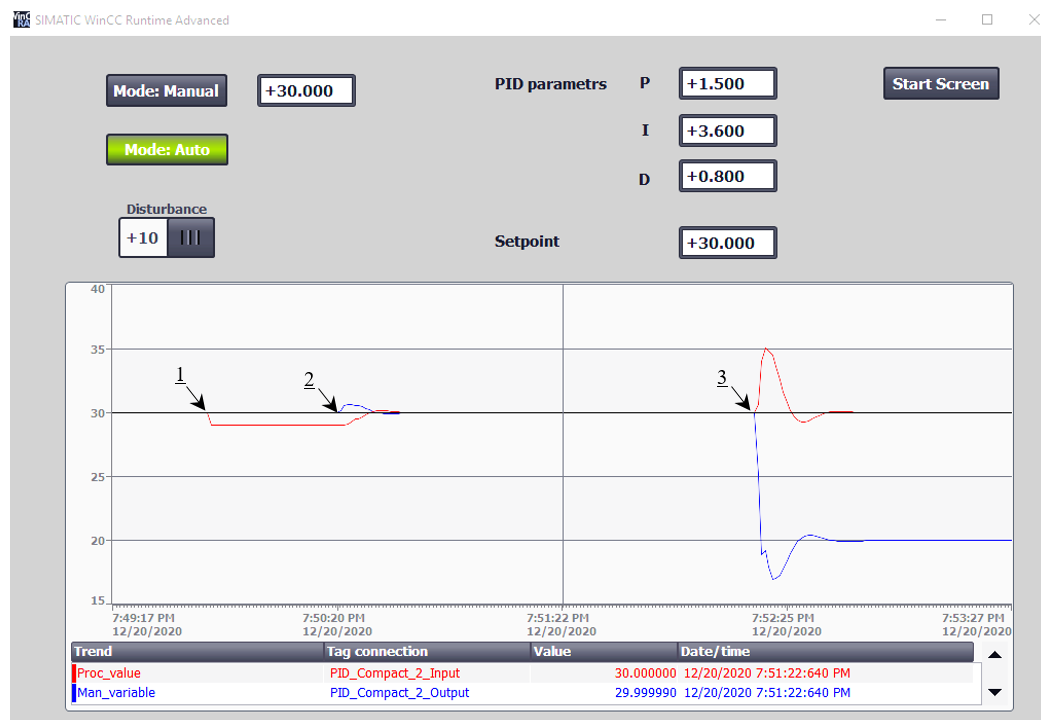
Рис. 6 – Результати моделювання CAP в середовищі TIA Portal: 1 – момент вмикавання ручного режиму керування; 2 – момент переходу в автоматичний режим; 3 – момент початку компенсації впливу зовнішнього збурення
