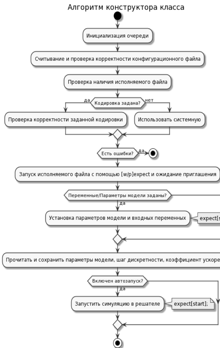
Рис. 3 – Структура и основные алгоритмы класса AppThread
