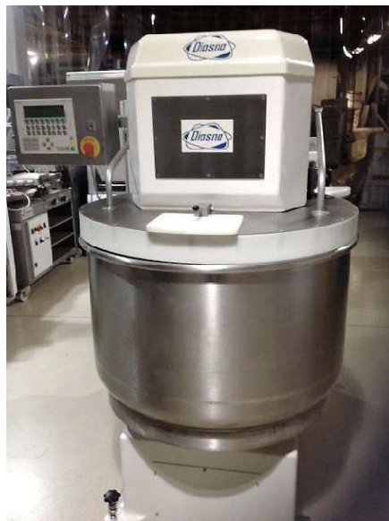
Рис. 2 – Тістомісильна машина Diosna SP 240
