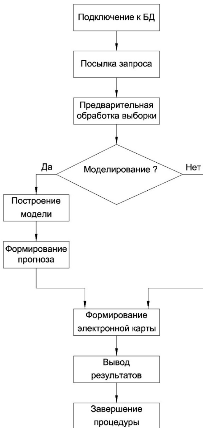
Рис. 2 – Алгоритм процедуры обработки данных мониторинга атмосферного загрязнения
