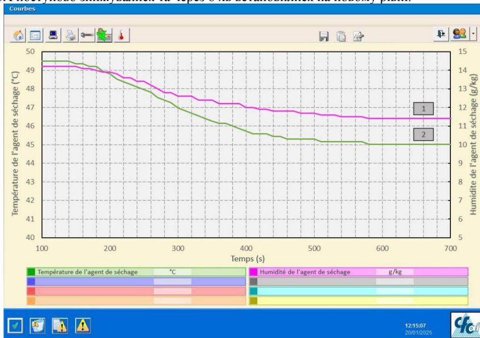
Рис. 3 – Динамічні характеристики ТН при зміні положення ТРВ Fig. 3 – Dynamic characteristics of the heat pump when changing the position of the thermal expansion valve
