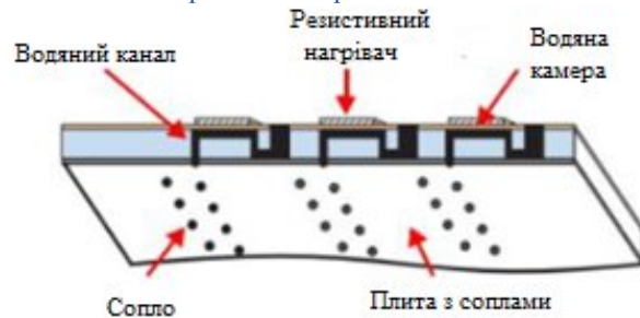
Рис. 1 – Структура термоструменевого дозатора Fig. 1 – Structure of a thermal jet dispenser
