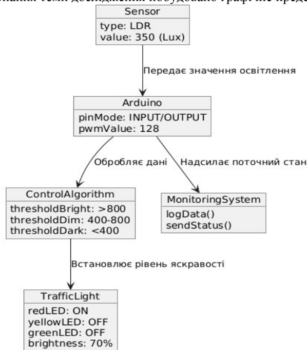
Рис. 6 – Діаграма об'єктів для адаптивної світлофорної системи Fig. 6 – Object Diagram for the Adaptive Traffic Light System
