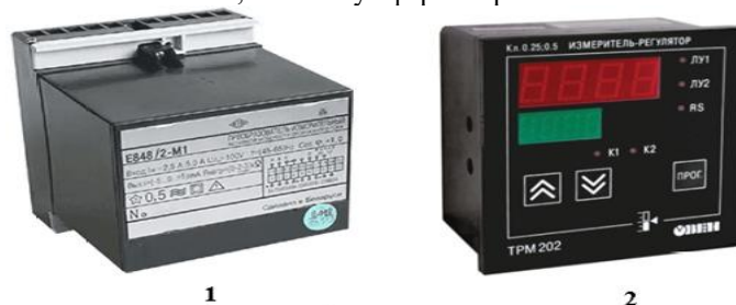
Рис. 4 – 1 – Перетворювач активної потужності; 2 – Двоканальний вимірювач регулятор Fig. 4 – 1 – Active power converter; 2- two-channel meter regulator
