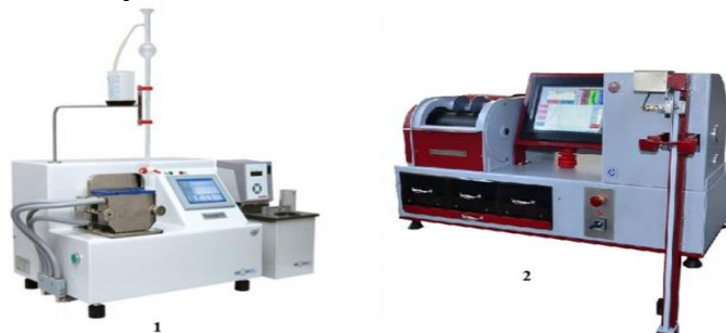
Рис. 2 – Прилади для визначення сили борошна: 1 – фаринограф; 2 – екстенсограф
