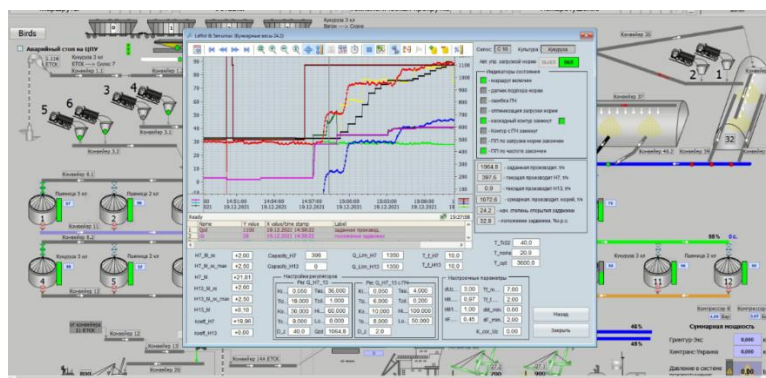
Рис. 3 – Загальний вигляд основного екрану АРМ оператора процесу перевантаження зерна АСУП елеватора з відкритим вікном АРМ налагодника АСОЗ ПТЛ
