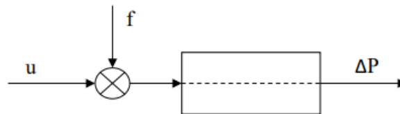
Рис. 2 – Параметрична схема процесу виробництва пари
